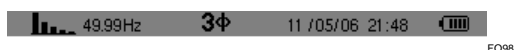
Figura 18: el signo 3\phi en la parte superior de la pantalla indica una configuración de conexión en trifásico equilibrado.
