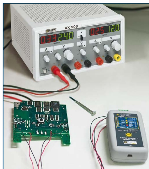
Enregistrement de deux sources de tension DC avec le modèle L432.
