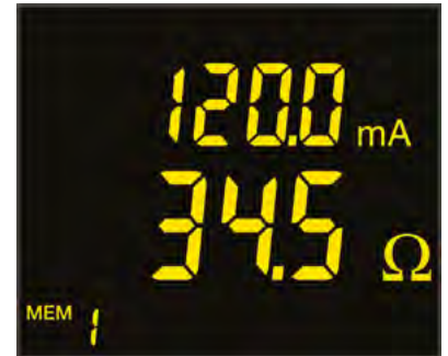
Modo estándar: Impedancia y corriente de fuga
