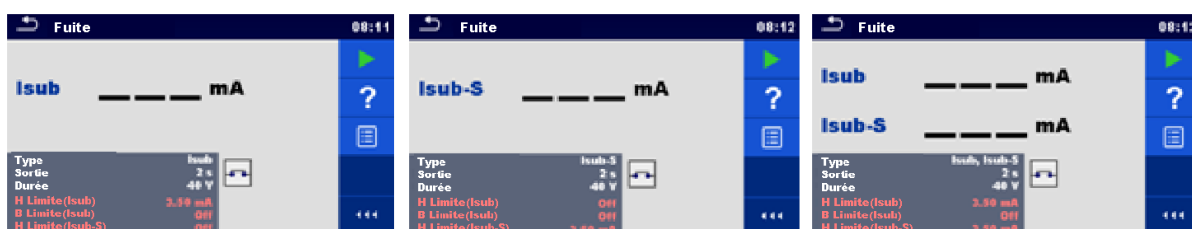
Figure 6.40 : Menus de test de courant de fuite par la méthode de substitution
