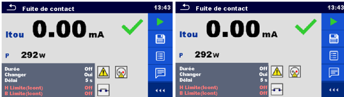
Figure 6.53 : Exemples de résultats de mesure de Courant de fuite de contact
