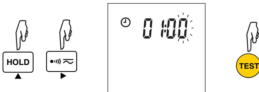
Al cabo de 10 minutos sin ninguna acción del usuario (pulsar una tecla o girar el conmutador), el instrumento se pone en modo de espera.
