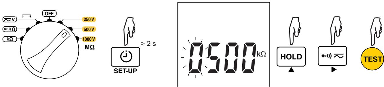
Utilice la tecla ▲ para ajustar el dígito y la tecla ► para pasar al siguiente dígito. Una vez ajustados los 4 dígitos, elija la unidad. Acepte pulsando el botón TEST.
