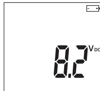
El instrumento genera internamente una tensión de 1.000 Vcc para dar la tensión de la pila durante el funcionamiento.
