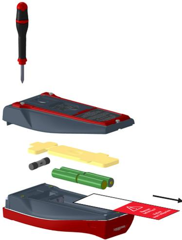
Desenrosque los 3 tornillos de cabeza Phillips y retire la membrana de la batería.
