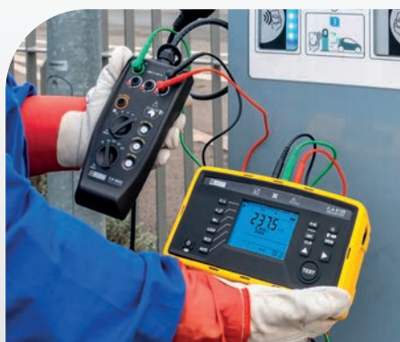
Control de tensiones suministradas por un punto de carga con ID de tipo A, durante la carga
