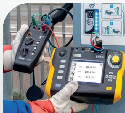
Control de tensiones suministradas por un punto de carga con ID de tipo B/EV 6mA, durante la carga
