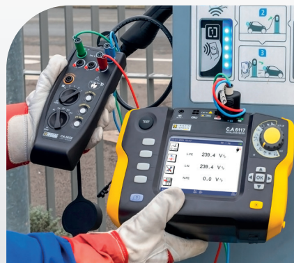
Controllo delle tensioni fornite da un terminale con DDR di tipo B/EV 6 mA, durante la carica.
