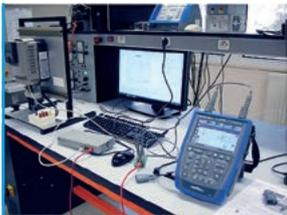
Scopix Bus est donc l'outil idéal pour analyser la couche physique. Il est également doté du mode Oscilloscope, multimètre et Logger, permettant ainsi des mesures précises sur les capteurs ou actionneurs du système, pour une maintenance toujours plus aboutie.
