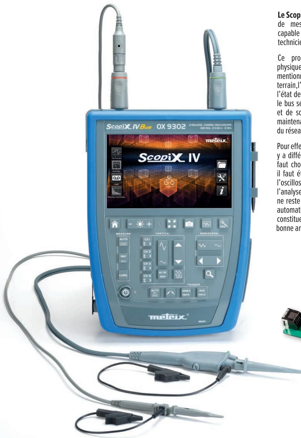
**Le Scopix IV Bus de Metrix®**, est un instrument de mesure robuste et simple d'utilisation capable d'effectuer cette analyse, menée par le technicien qui installe le bus de terrain.
