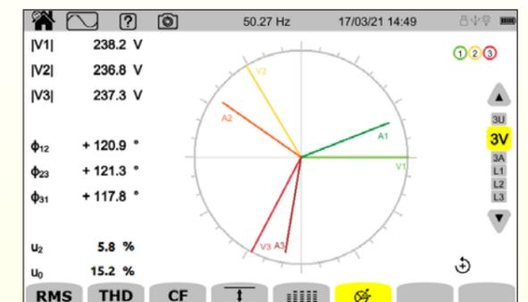
Avec un diagramme vectoriel on affiche la relation de phase entre les tensions et les courants. La représentation vectorielle permet une validation de la connexion de l'appareil au réseau.
