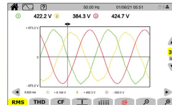
Le mode Forme d'onde fournit, sous la forme d'un oscillogramme, les formes d'onde de tension et/ou de courant automatiquement.
