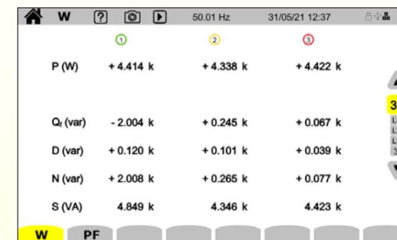
Le CA8345 permet de surveiller, sur des campagnes plus ou moins longues, toutes les puissances en temps réel (P, Q, D...). La mesure puis l'analyse de toutes les puissances mesurées permet d'établir un bilan de puissance complet selon les normes.
