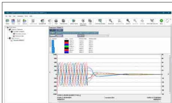
Le logiciel Power Analyzer Transfer réalise l'exploitation des mesures effectuées avec le Qualistar Class A.
