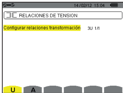
Figura 26: la pantalla Ratios de tensión en el menú Sensor y ratios en el caso de un montaje sin neutro
