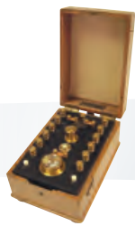
Ce potentiomètre d'étalonnage de 1900 s'utilisait avec une pile étalon et un galvanomètre comme celui présenté ci-dessus. Son prix : 195 francs !
