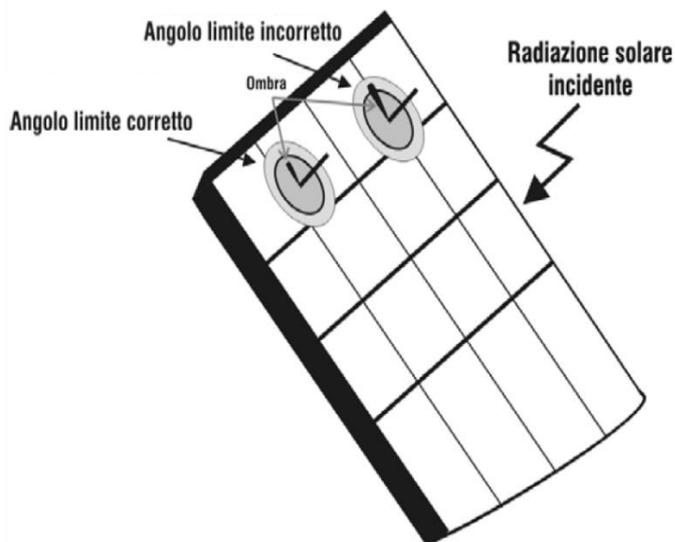
**UNITA' REMOTA:** l'Unità Remota deve essere posizionata in modo corretto sullo stesso piano dei moduli da analizzare, è necessario accertarsi inoltre che non vi siano ombreggiamenti, onde evitare misure non reali. Fissare l'Unità Remota direttamente al telaio del modulo oppure alla struttura portante tramite la staffa fornita in dotazione (verificate eventuali ombreggiamenti causati da un'eventuale errata posizione del sensore).
