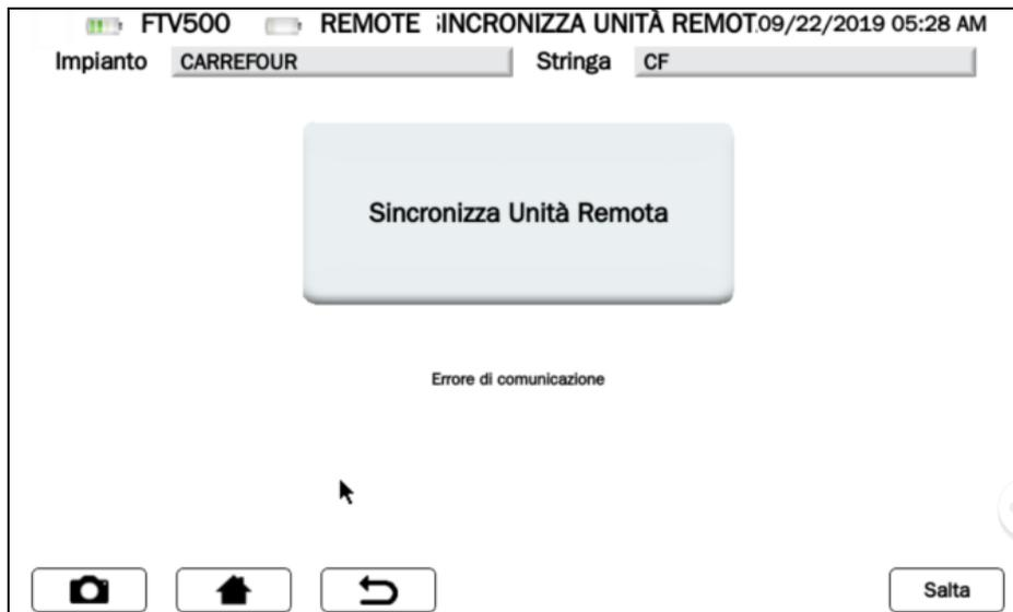
Figura 14.7.1-3 Schermata di sincronizzazione unità remota: errore di sincronizzazione
