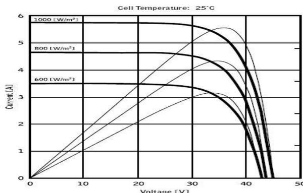
Su ogni curva caratteristica esiste uno ed un solo punto tale per cui è massimizzato il trasferimento di potenza verso un ipotetico carico alimentato dal modulo fotovoltaico. Il punto di massima potenza corrisponde alla coppia tensione-corrente tale per cui è massimo il prodotto  $V \cdot I$ , dove  $V$  è il valore della tensione ai morsetti del modulo e  $I$  è la corrente che circola nel circuito ottenuto chiudendo il modulo su un ipotetico carico.
