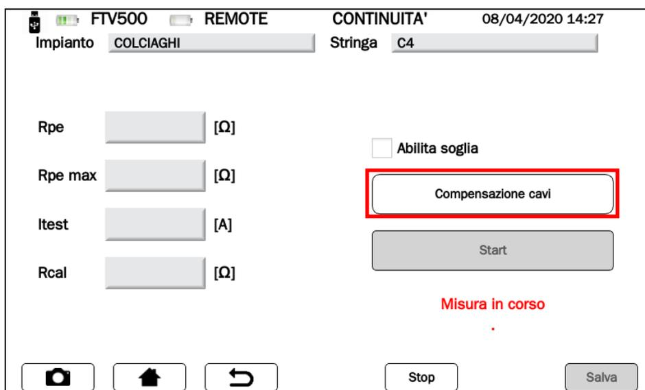
Figura 14.7.5.2-2 Schermata di misura in corso compensazione cavi
